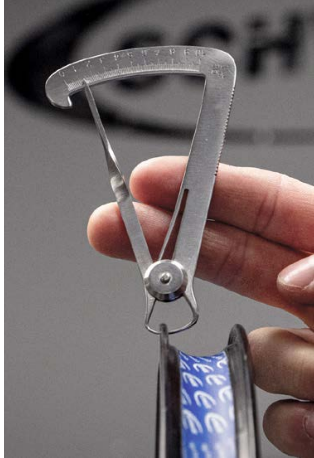
Felgenflanken mit weniger als 1 mm Wandstärke sind von der Montage ausgeschlossen.
